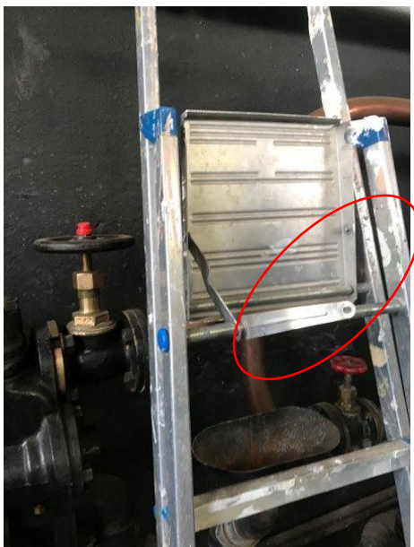
Defecte trap en ladder
