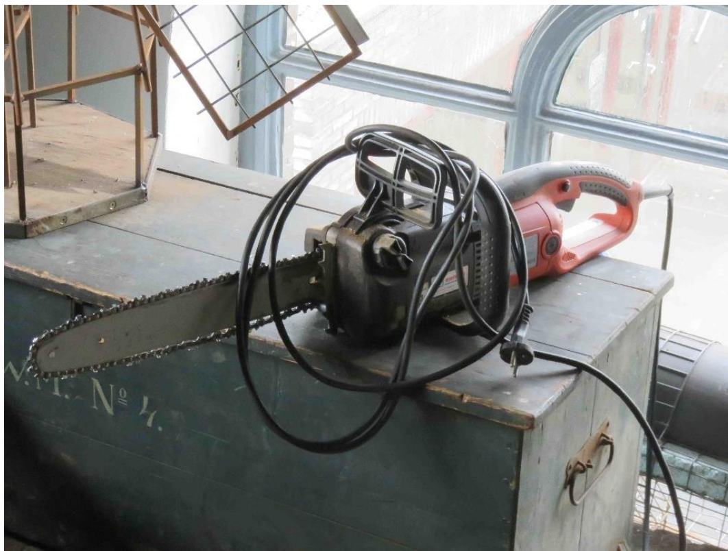
Elektrische kettingzaag met door gebruiker gemodificeerde kabelaansluiting
